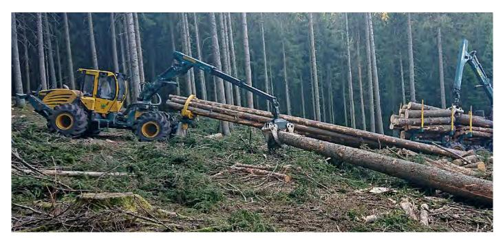
Oben: Im HSM 805HD ackert ein Vierzylinder von Volvo Penta mit 238 PS. Dank eines starken Hinterwagens, wie er vom Hersteller auch für den HSM 904 verwendet wird, schultert der 805HD einen schweren Kran der Epsilon-X-Klasse. Das ist bei diesen dicken Fichten und Tannen auch nötig. Aufgearbeitet werden sie von einem HSM-Harvester 405H3 (rechts und unten rechts).
